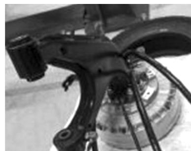
图 10 轮毂电机试验样机
