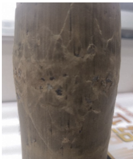
图4 岩堆相似材料三轴试验试样变形特征
