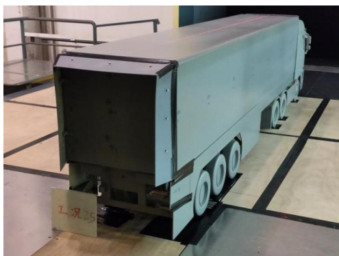
图16 尾部导流片方案示意
