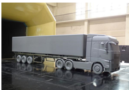
图1 模型在试验平台安装展示图
