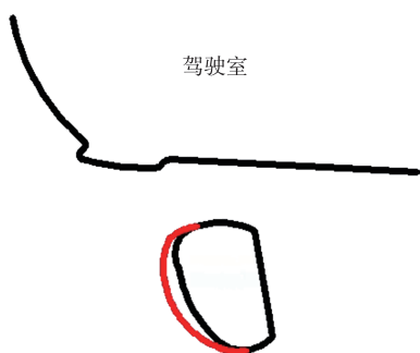
图 8 后视镜曲率变化示意图(前凸部分为改变后)
