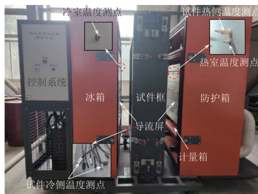
图2 试验设备(热箱包含防护箱和计量箱)
