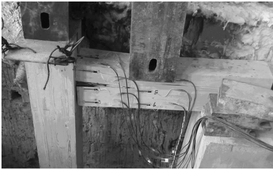
图 5 梁柱式榫卯节点承载力试验破坏图
