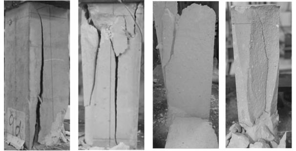
图8 棱柱体试件的典型破坏状态
