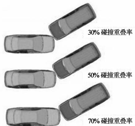
图2 不同重叠率工况下车车仿真碰撞模型
