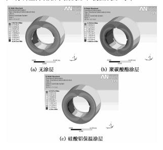
图 6 不同种类涂层下的轴承径向热变形分布 Fig. 6 Bearing radial thermal deformation under different types of coating distribution
