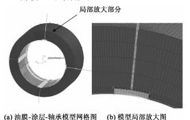
图 2 油膜-涂层-轴承模型网格图 Fig. 2 Film-coating-bearing model grid chart
