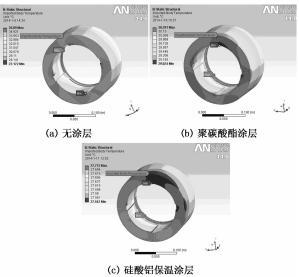
图 5 不同热导率涂层的轴承温度场分布
