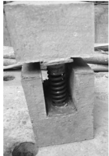
图 3 三维复合隔震墩实物图
