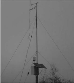
图 2 观测站风速仪
