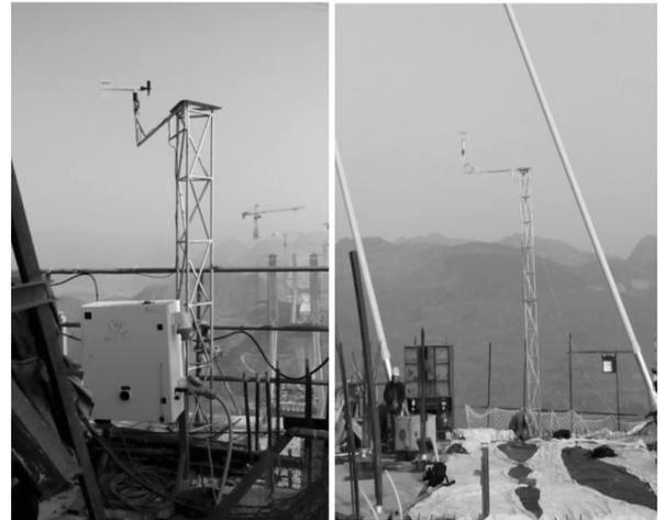
(a) 桥面二维机械风速仪
