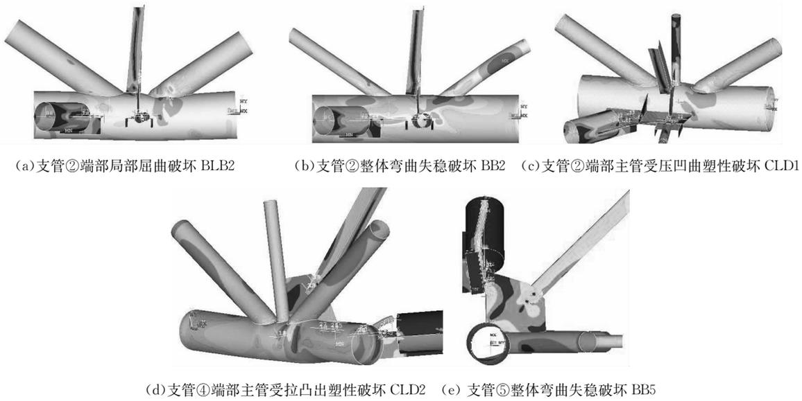
图 11 节点破坏形态图
