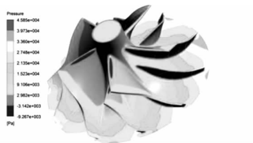
图 5 叶轮表面静压场
