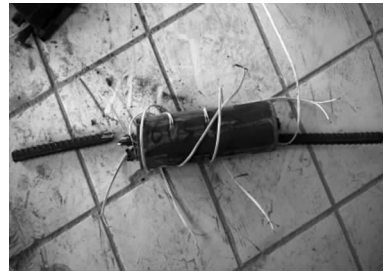
(a) 钢筋拉断破坏
