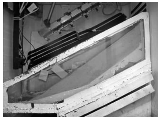
图 3 泥石流模型槽
