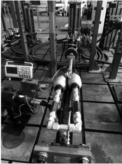
图3 液-电馈能单元的样机台架试验
