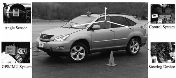
图 15 Lexus 试验车辆的整体设置与安装
