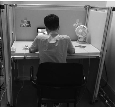
图2 工位辐射空调加桌面风扇装置实物图
