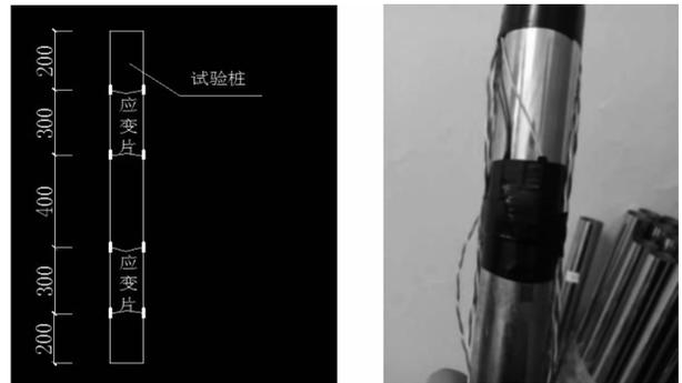
图 3 模型桩应变片布置及粘贴图
