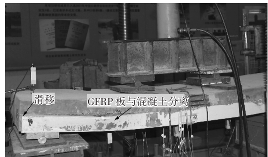
(b) 试件D3发生GFRP板与混凝土分离破坏
