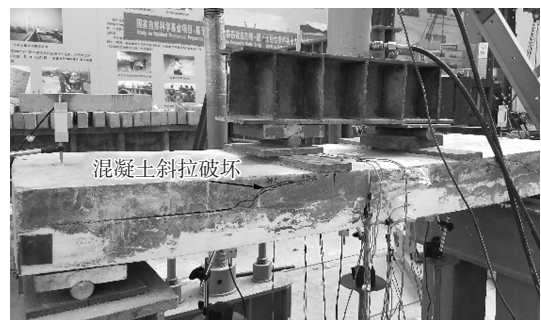
(c) 试件D4发生混凝土斜拉破坏
