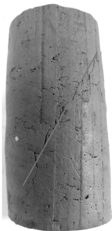
图 4 固化土破坏形式 Fig.4 Solidified soil destruction
