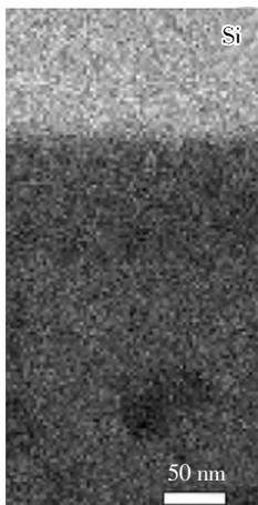
(e) 图(c)方框区域的 Si 元素分布能谱图
