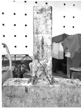
图 4 试件 U-N1 破坏形态 Fig.4 Failure mode of specimen U-N1
