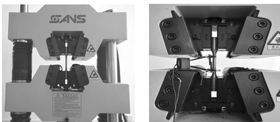
(a) 试验仪器 (b) 量测装置 图2 单轴拉伸试验装置
