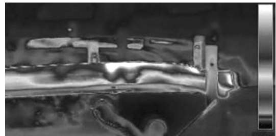
图 9 A 柱边梁大头背侧温度分布
