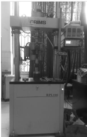
图3 RPL100 电子式蠕变疲劳实验机
