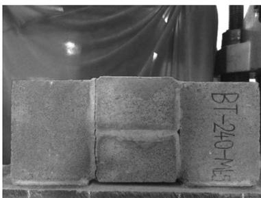
图4 试件剪切破坏照片
