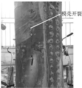
图10 钢板侧模壳开始出现裂缝
