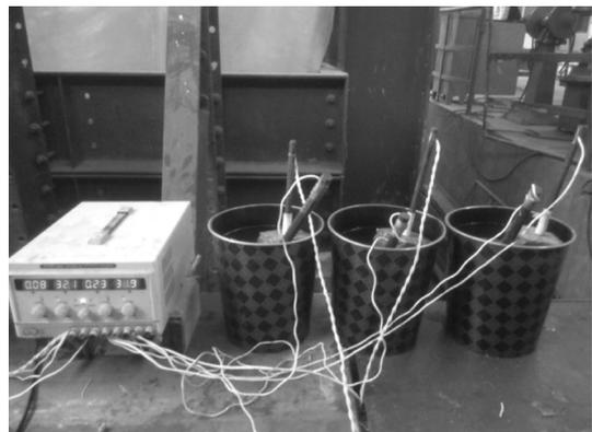
图3 电化学装置
