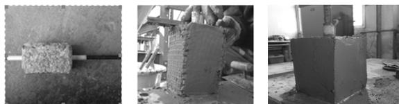
(a) 试件凿糙处理 (b) 试件一层加固 (c) 试件加固完成
