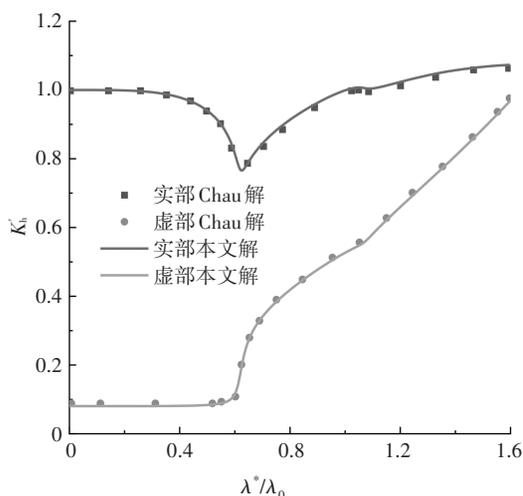
图 3 无量纲水平动力阻抗  $K_h'$  随频率的变化对比
