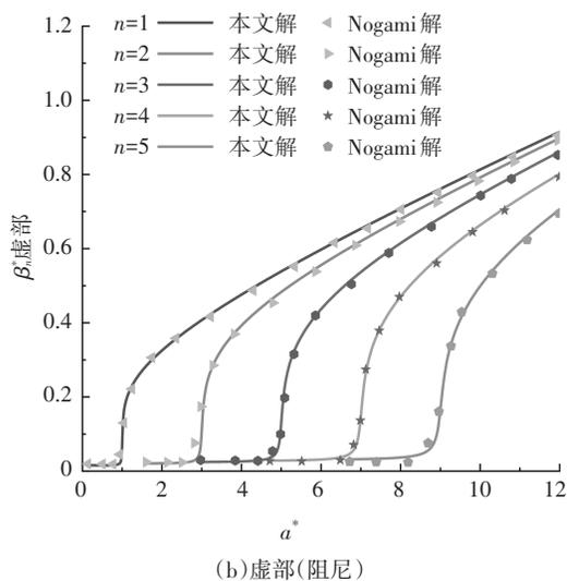
图 2 不同振动模式  $n$  下, 土体阻抗因子  $\beta_n^*$  随频率  $a^*$  的变化对比
