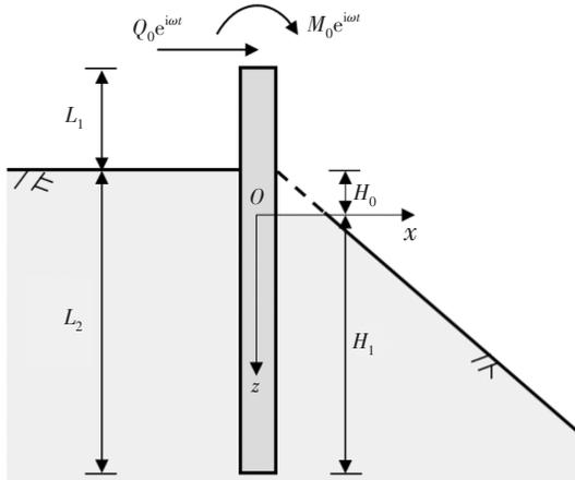
图 1 斜坡基桩计算模型简图
