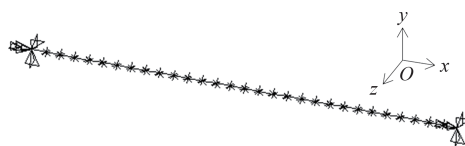
图 3 简支梁有限元模型
