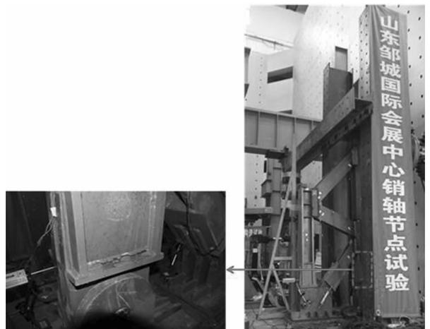
图 19 试件 4 破坏形式
