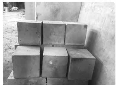
图 4 混凝土立方体试块
