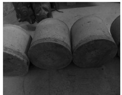
图 3 涂抹复合砂浆的混凝土试块
