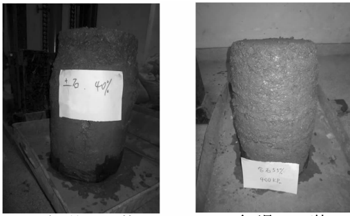
(a) 含石量 40% 三轴 试验破坏试样
