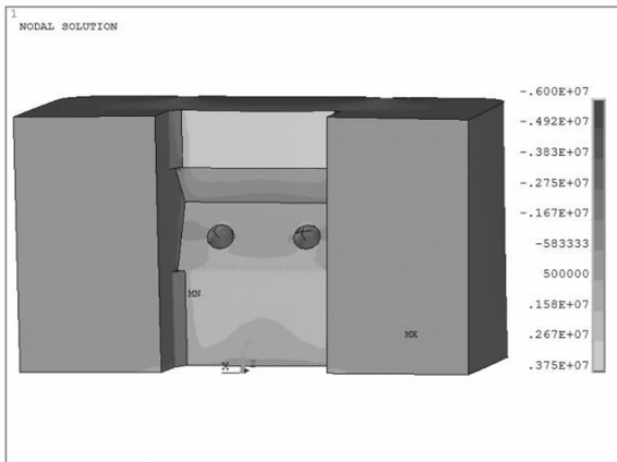
(c) 前墙内侧横桥向(X向)应力云图(Pa)
