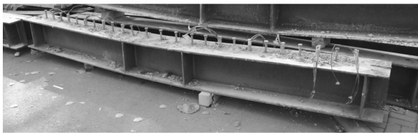
图 8 组合梁静力破坏模式
