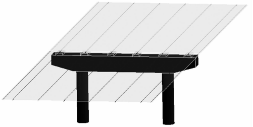
图 4 桥梁整体有限元模型
