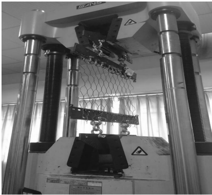
图2 绞边拉伸试验 Fig. 2 Selvage stretching tests
