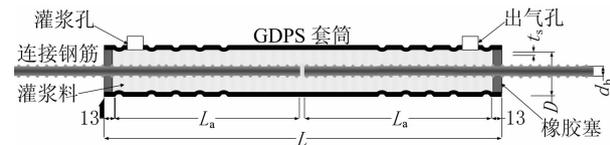
图 2 试件尺寸(单位:mm)
