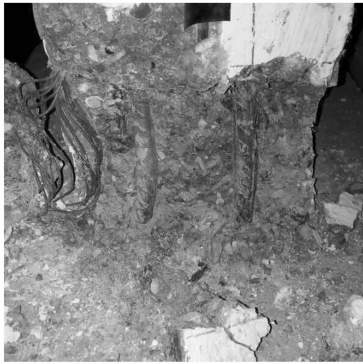
(c) 试件 HDCW1 局部压溃
