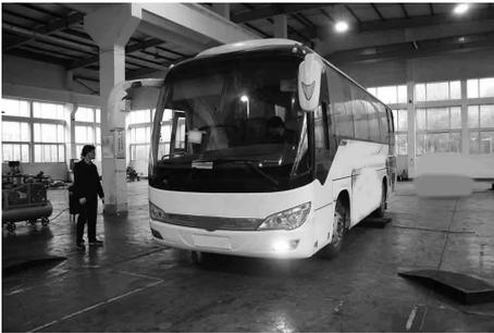
图4 某客车跌落试验现场图
