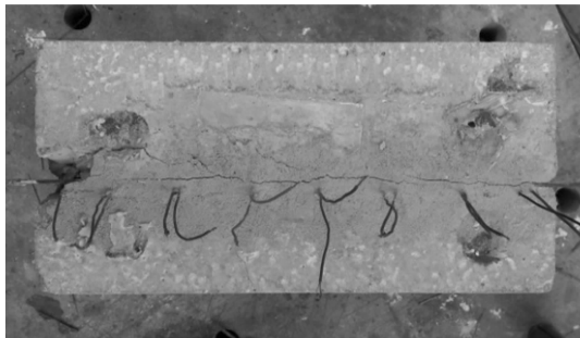
图 5 试件 C30-L300-300 的黏结剥离破坏形态 Fig. 5 Debonding failure of specimen C30-L300-300
