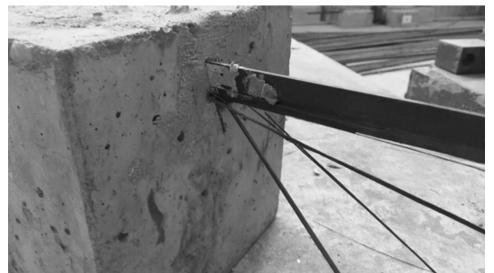
图 6 试件 CA30-L300-300 的黏结剥离破坏形态 Fig. 6 Debonding failure of specimen CA30-L300-300
