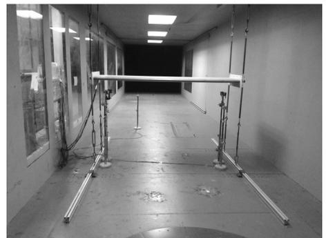
(a)弹性悬挂主梁节段模型照片
