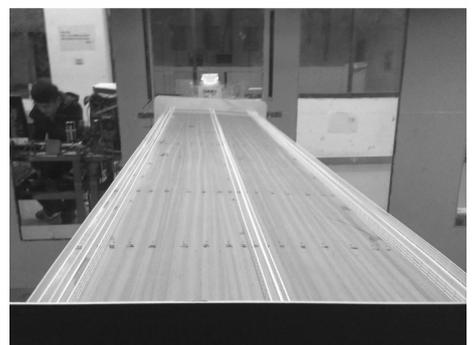
(b)主梁节段模型桥面布置照片
