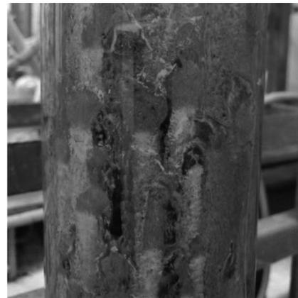
图 10 脱氮塔中的腐皮镰刀菌(白色部分)
