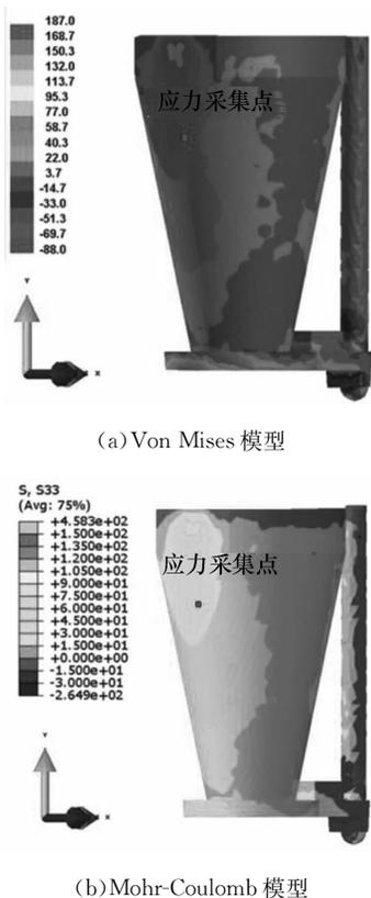
图 6 覆砂 4 mm 铸件 Z 方向残余应力云图
