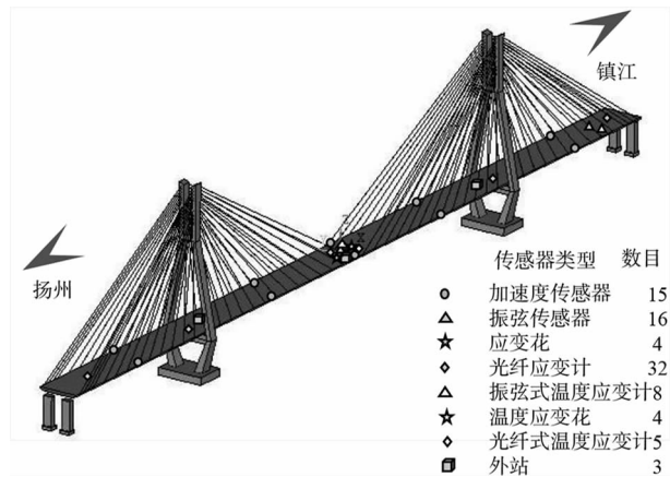
图 2 润扬斜拉桥健康监测系统的传感器类型及其位置
