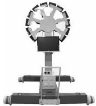
图 1 移动式地铁隧道结构病害检测系统 Fig. 1 Movable tunnel inspection system (MTI-100)
