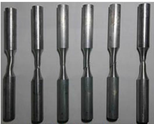
图 7 试件破坏形态
