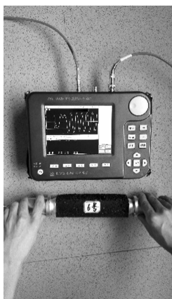
图 4 波速测试 Fig.4 Wave speed test
