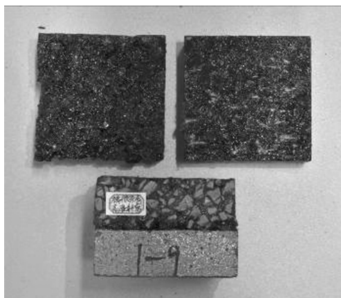
图 5 沥青黏结剂复合试件剪切破坏形态
