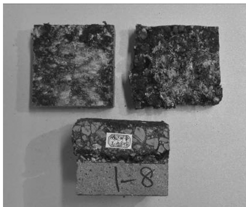
图 4 环氧黏结剂复合试件剪切破坏形态
