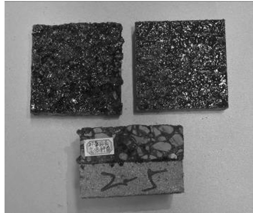
图 6 环氧沥青黏结剂复合试件剪切破坏形态
